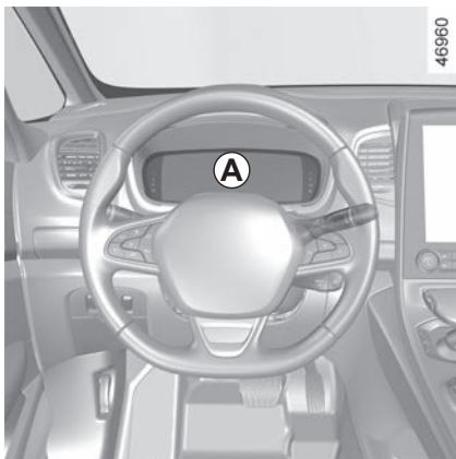
Tablica wskaźników A zostaje podświetlona przy włączeniu zapłonu.
